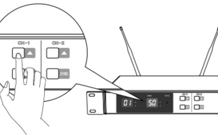
将发射机与接收机设定为一致的频点时，接收机接收到此通道的无线电射频信号，此指示灯会亮。
