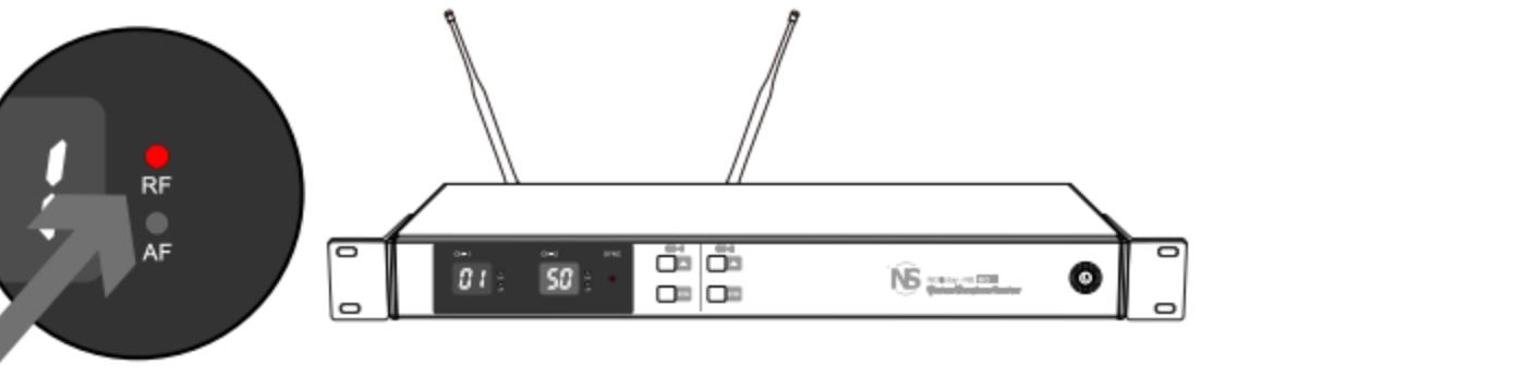
3、将发射机红外对频窗口对准接收机的红外对频窗口按“Sync”按键对频（对频过程中，接收机 SYNC 对频灯闪烁）。
