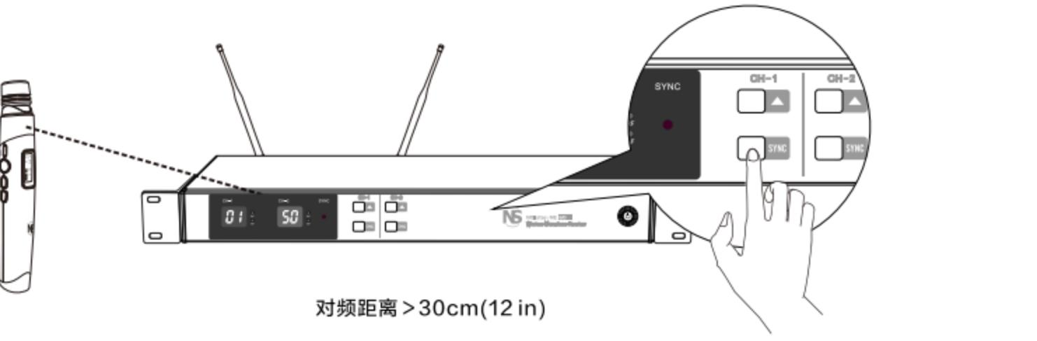
若使用红外扩展同步器时，接收机将增加一个无需手动对频功能，只要把接收机与发射机在 30CM 左右的范围内对准扩展同步器，即可人性化的自动同步功能；完成同步后，红外扩展同步器就会产生“嘀”的声音。
